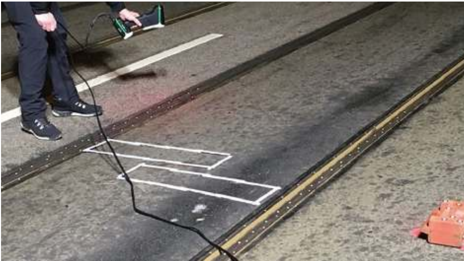
Abb. 4: Ermittlung der Gleisgeometrie Quelle: CE cideon engineering (Aufnahme während Messkampagne)
